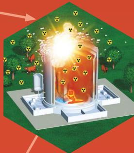
En cas de perte d'étanchéité non anticipée et de dégradation du bâtiment, les produits radioactifs se dispersent dans l'atmosphère formant un panache invisible, emporté par le vent ou étalé sur le sol par la pluie.
