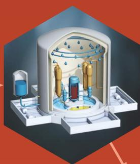
Les circuits de refroidissement de secours entrent en action (réservoir extérieur).
