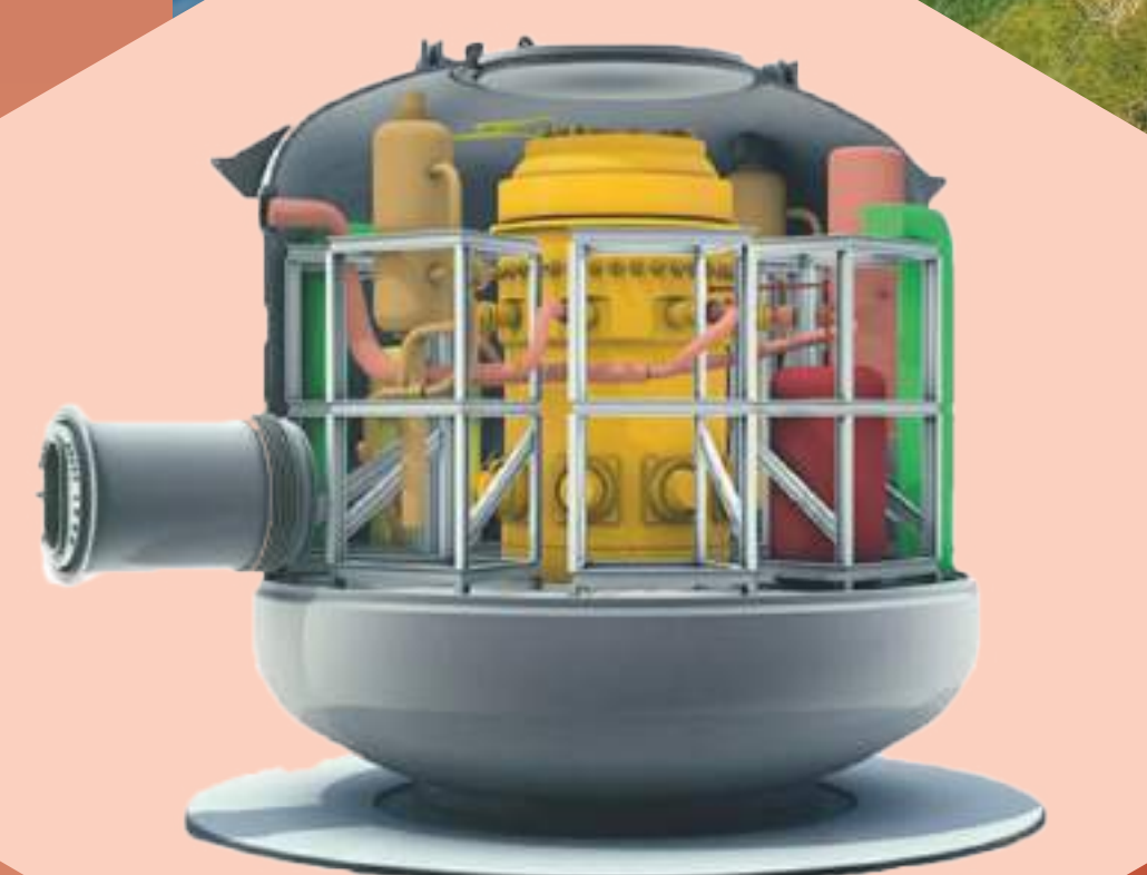
Chaudière et enceinte NUWARD™ dans la vue d'ensemble du bâtiment nucléaire principal.
