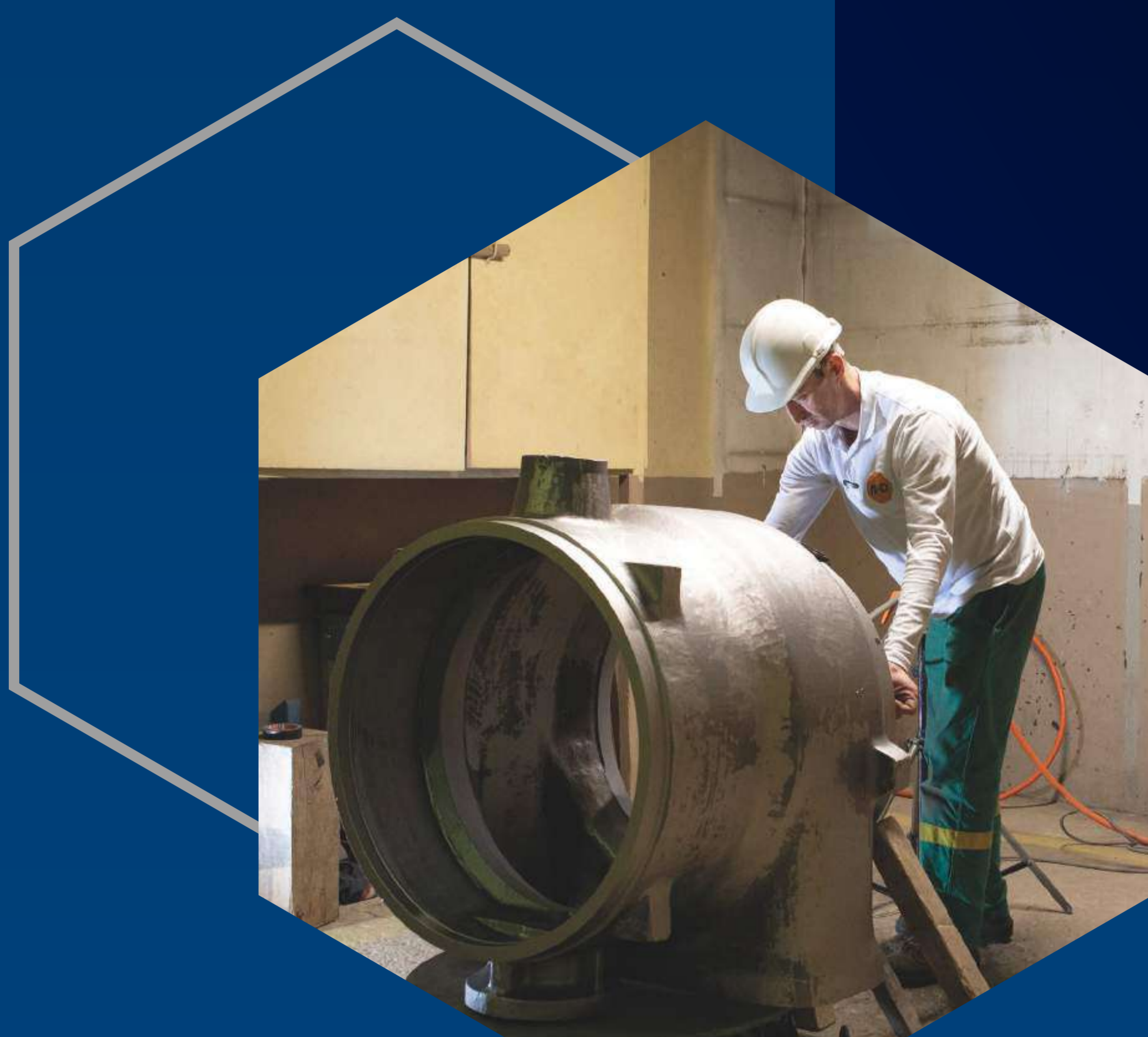
Un technicien prépare un tir de gammagraphie pour inspecter une lourde pièce de chaudronnerie. Ils ont été spécifiquement formés et vont s'éloigner au moment du tir.
