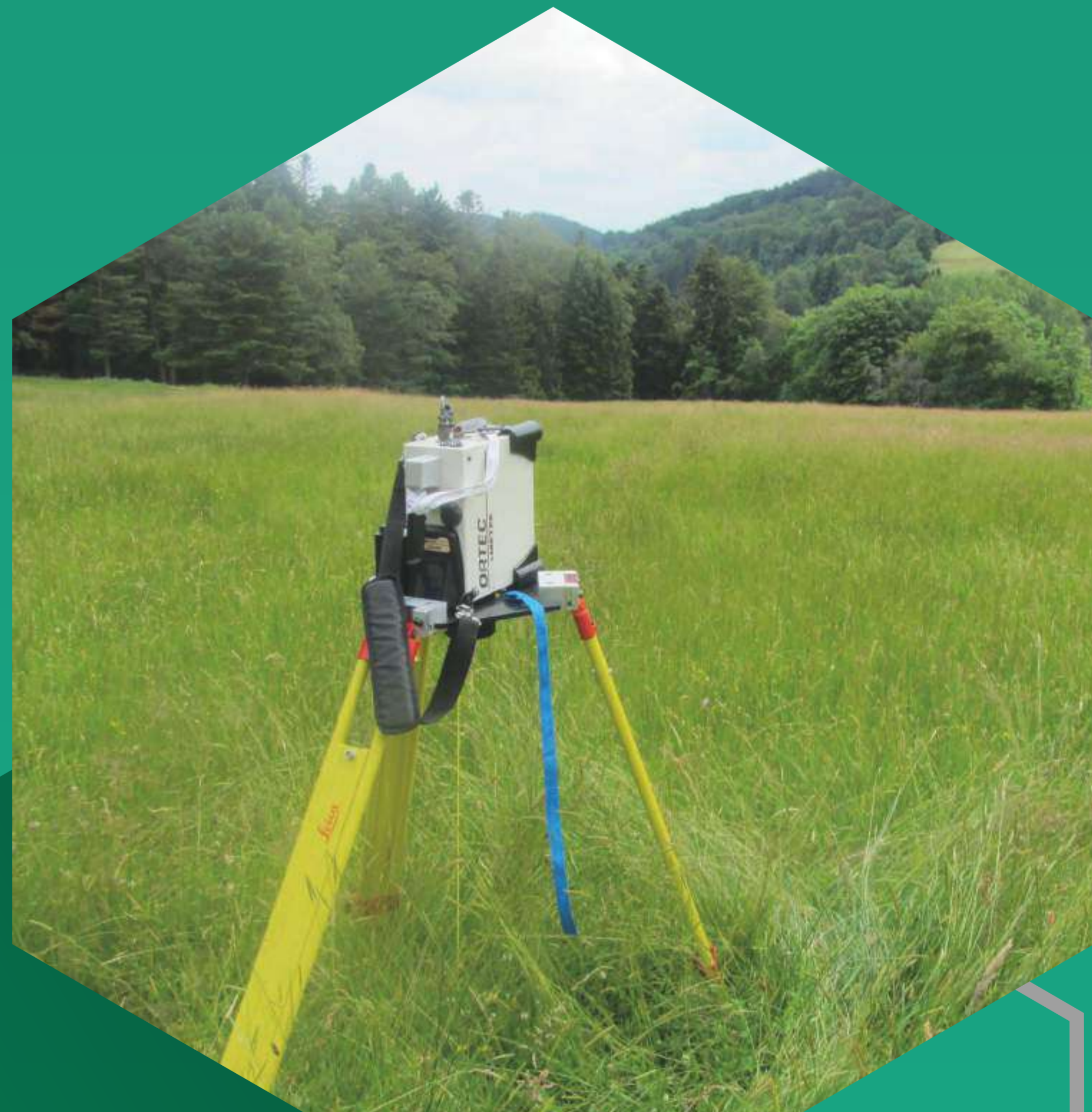
Mesure en spectrométrie gamma in situ à proximité de la centrale nucléaire de Saint-Alban.
